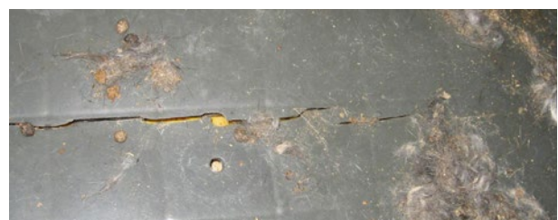
So bitte nicht! Keine defekten und verschmutzten Transportkisten verwenden. Risse, scharfe Bruchkanten und spitze Teile stellen eine Verletzungsgefahr dar.
